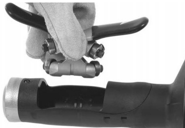
Рис. 12В – Снятие с корпуса устройства автоподачи AUTOFEED
