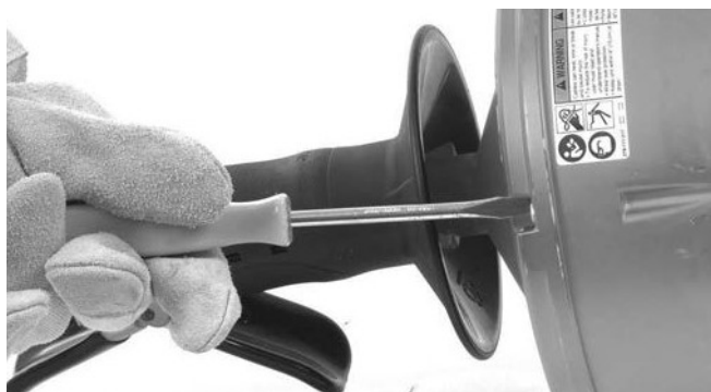
Рис. 13 – Отверните 4 винта барабана примерно на 3 полных оборота, но не извлекайте винты
