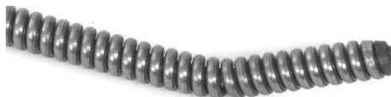
Рис. 15 – Изгиб на конце троса
