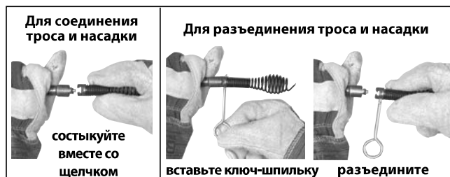
Рис. 7 – Подсоединение и отсоединение насадок
