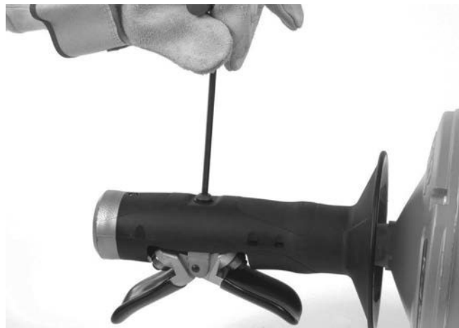
Рис. 12А – Отворачивание винта крепления устройства автоподачи AUTOFEED
