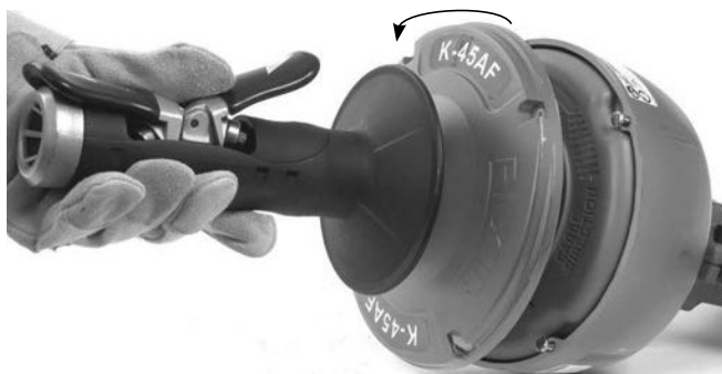
Рис. 14 – Проверните и разъедините крышки барабана
