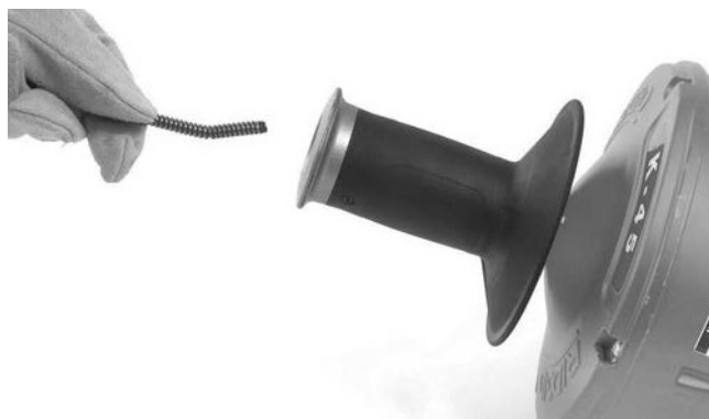
Рис. 17 – Заправка троса без замены внутреннего барабана
