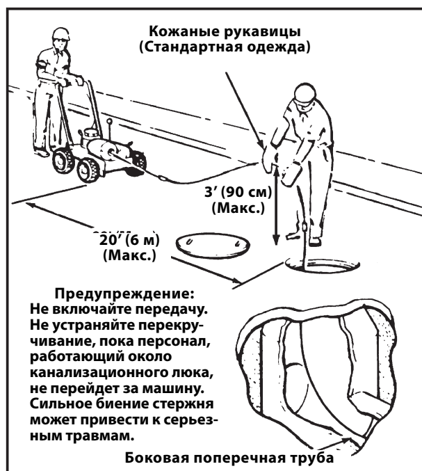
Рис. 3 – Использование стержневой прочистной машины
