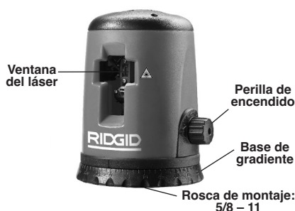
Figura 2 – Partes del Láser
