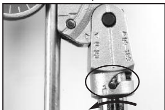
Figura 12 – Pasador en posición "abierto"
