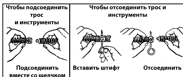
Рис. 1: Соединение и разъединение тросов и инструментов
