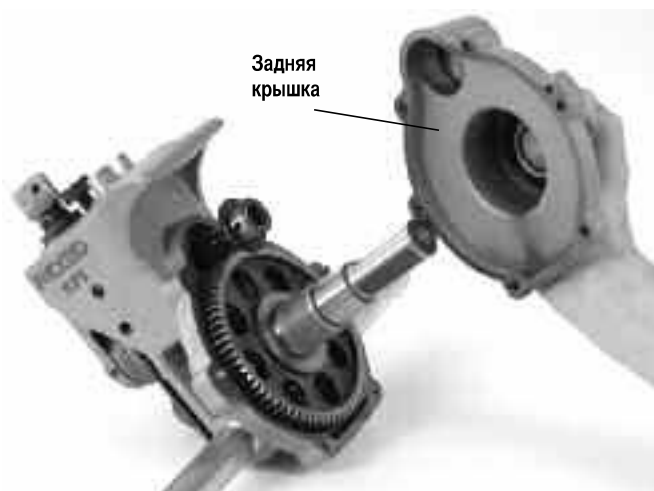
Рисунок 18 – Снятие задней крышки
