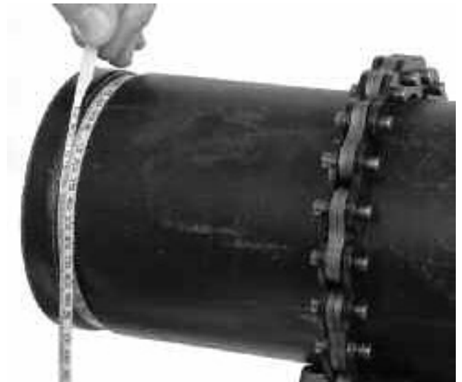
Рисунок 16 – Проверка диаметра желобка с помощью измерительной ленты
