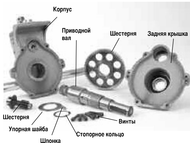
Рисунок 20 – Обозначение компонентов устройства для накатки желобков 975 Combo
