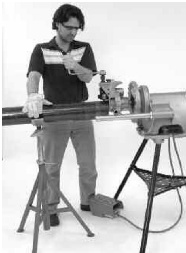
Рисунок 13 – Нажим на трубу с целью улучшения прокатки
