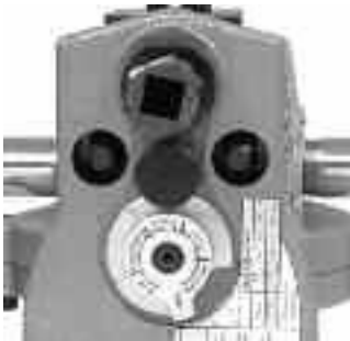
Рисунок 10А – Выбор положения регулятора глубины желобка под головкой регулировочного винта
