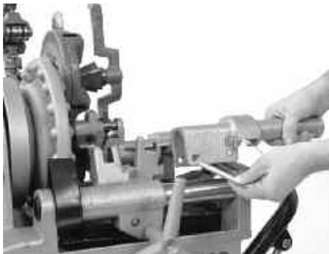
Рисунок 5 – Установка скобы адаптера
