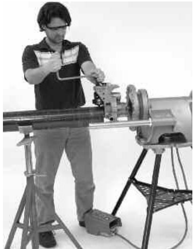
Рисунок 12 – Рабочая позиция устройства для прокатки желобков
