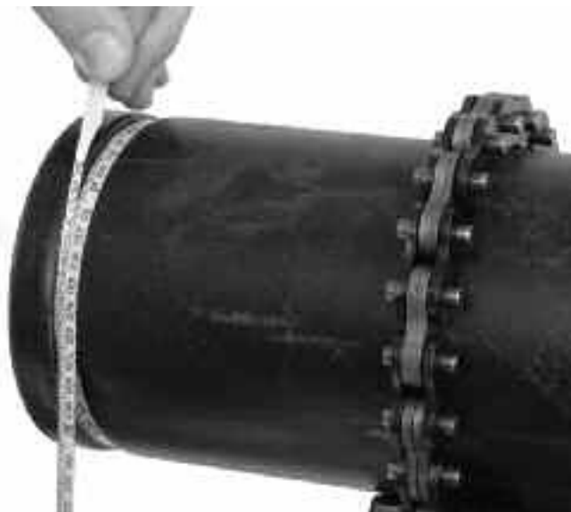
Рисунок 11 – Проверка диаметра желобка с помощью измерительной ленты
