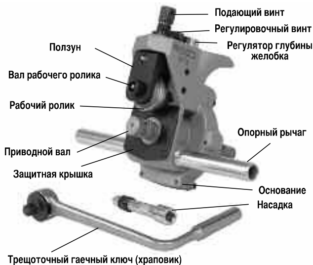
Рисунок 1 – Устройство для накатки желобков 975 Combo
