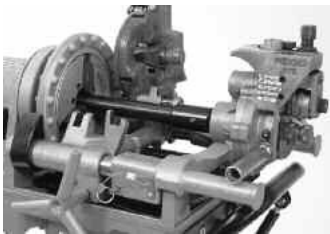
Рисунок 6 – желобонакатчик 975 Combo правильно установлен на резьбонарезном станке RIDGID 300 Compact
