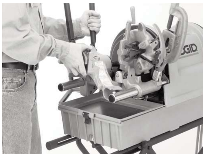
Рисунок 4 – Монтаж на резьбонарезной станок 1822-I (то же для станков 300 Compact и 535)
