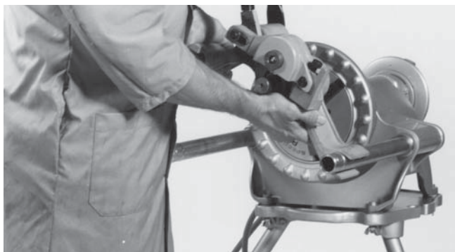
Рисунок 2 – Установка на силовой привод № 300
