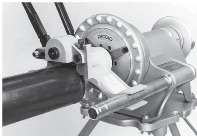
Рисунок 9 – Подающий рычаг в верхнем положении
