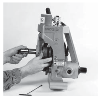
Рисунок 18 – Снятие удерживающего вала и накаточного ролика
