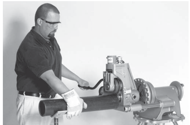
Рисунок 15 – Нажим на трубу, когда силовой привод работает в режиме FOR
