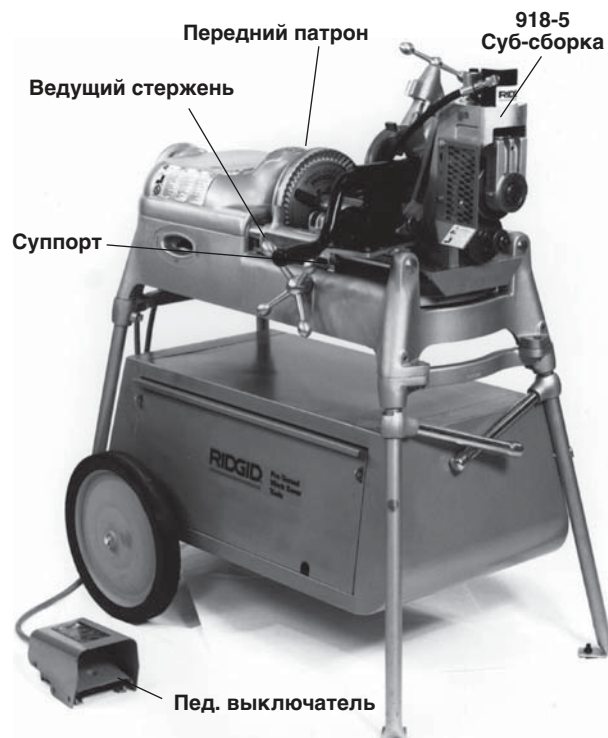
Рисунок 8 – Желобонакатчик № 918-5 на резьбонарезном станке № 535
