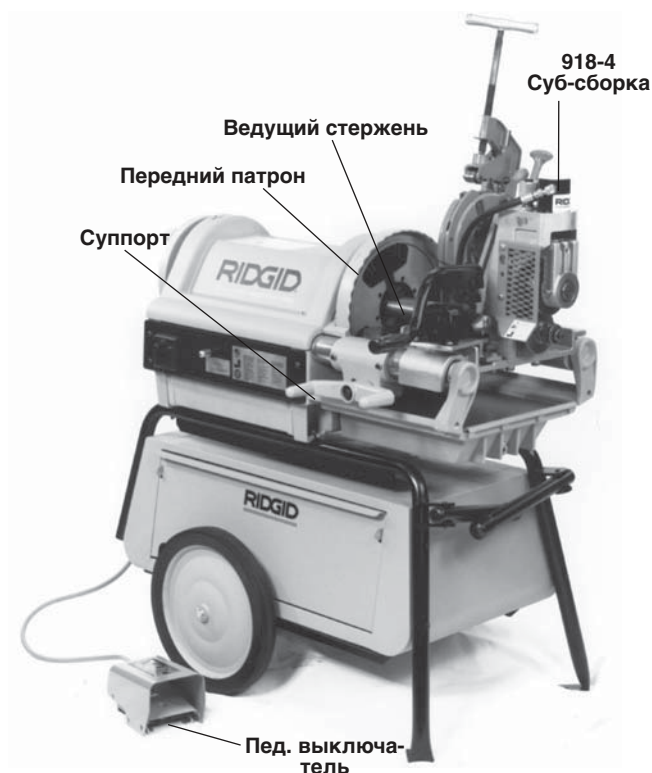
Рисунок 6 – Желобонакатчик № 918-4 на резьбонарезном станке № 1224
