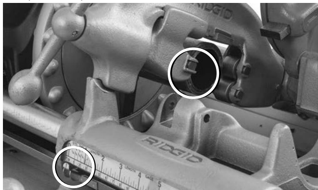
Рис. 20А – Лезвие режущего диска подведено к торцу трубы. Установите указатель на ноль (0)
