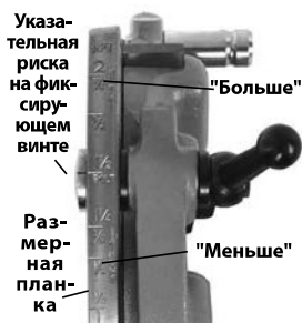
Рис. 11 – Настройка размера резьбы
