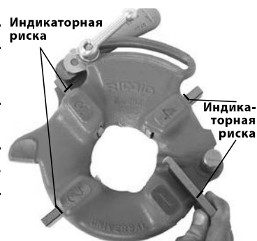
Рис. 6 – Установка резьбонарезных гребенок
