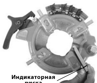
Рис. 14 – Установка резьбонарезных гребенок
