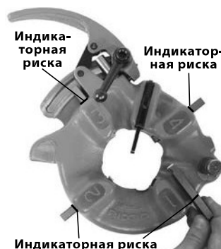
Рис. 10 – Установка резьбонарезных гребенок
