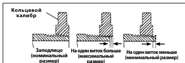
Рис. 27 – Проверка размера резьбы
