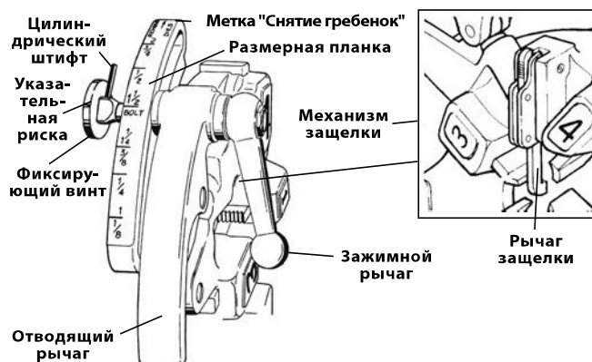
Рис. 8 – Универсальная самооткрывающаяся резьбонарезная головка
