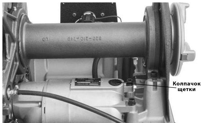
Рис. 34 – Снятие крышки электродвигателя/замена щеток
