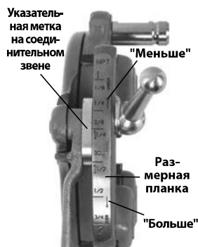
Рис. 7 – Настройка размера резьбы
