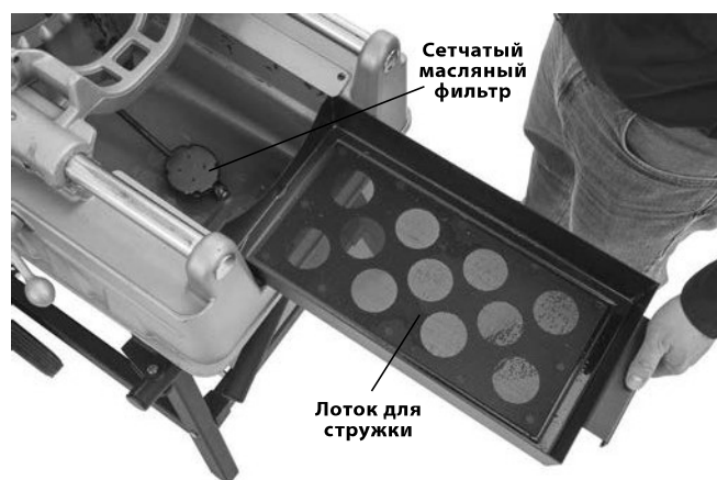
Рис. 30 – Снятие лотка для стружки
