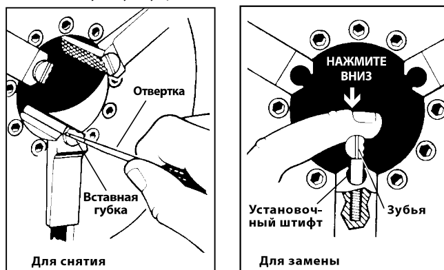
Рис. 33 – Замена вставных губок
