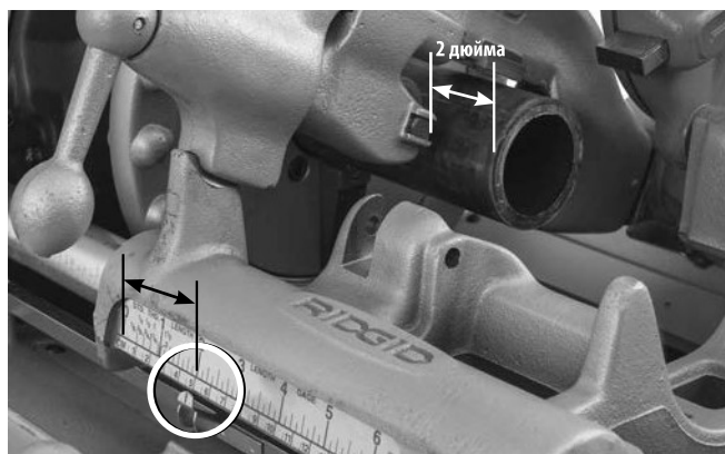
Рис. 20В – Указатель линейки установлен на требуемую длину
